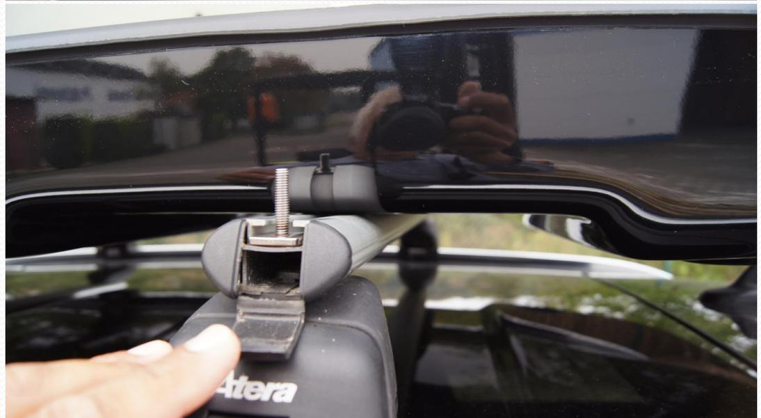
Box anheben und T-Stein jeweils unter die Box in den Schlitz führen
